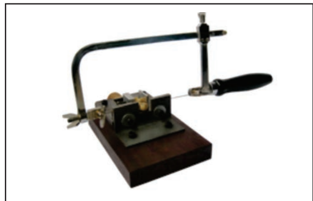
Figura 3. Micrótopo diseñado por el grupo de estudio con el fin de realizar cortes calibrados exactamente. El aparato consta de un tornillo micrométrica y un tornillo micrométrico para poder estandarizar los microcortes coleares.
